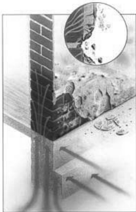
Rys. 7.1. Podciągana kapilarnie wilgoć z miejsc bezpośredniego styku między murem a glebą [4]
